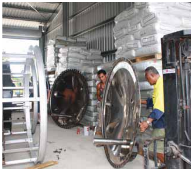
L'atelier de moulage de citernes construit à Niue.
